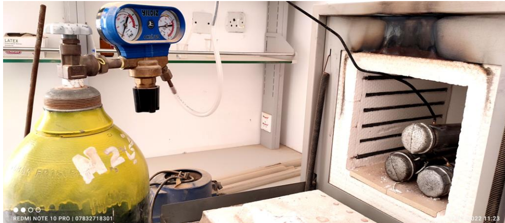
شكل 2: وضع المفاعل داخل الفرن وربطه بقنينة غاز N 2
