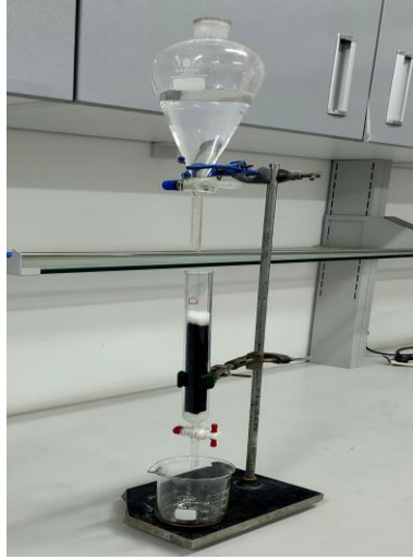
شكل 3: مرشح تنقية المياه الجوفية
