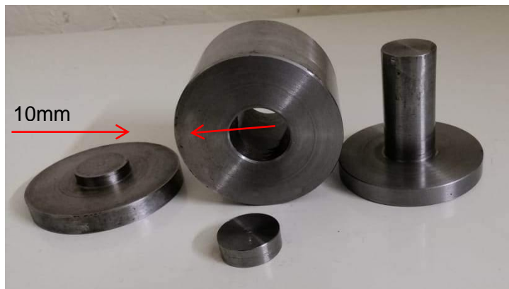
شكل 1: القالب المستخدم لكبس المساحيق.
